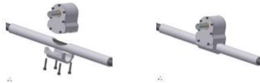
4.17- сурет - Рейканы корпусқа бекіту
