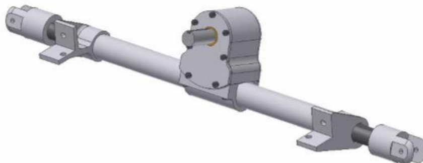
4.20- сурет- Рульдік басқарманың жиналған үлгісі
