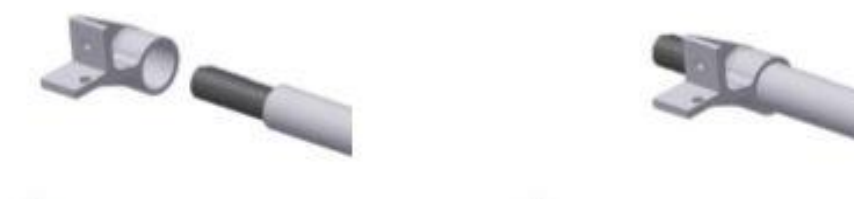
4.18- сурет -Рейкаға екі тірегін кигізу
