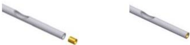
4.13- сурет -Тұтқаға екі төлкенің орналасуы
