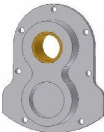
4.7- сурет - Тістегершіктің корпусының қақпағы
