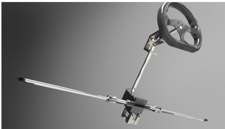
4.2-сурет- Рульдік рейка моделі
