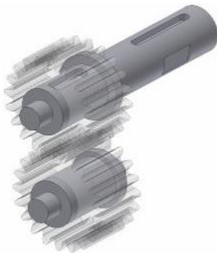
4.10 – сурет - Жетекші тістегершіктер және біліктердің орналасуы
